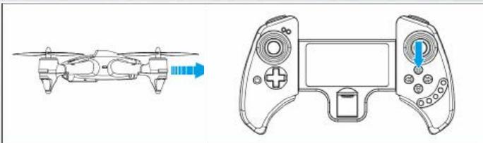
Si el dron se mueve hacia delante mientras está avanzando presione el botón de recorte hacia atrás, hasta que el dron deje de avanzar
